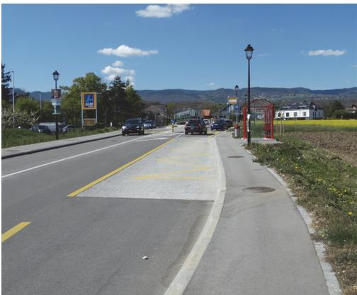
**Mesure C4 :** intersection Route de Genolier – carrefour Mimorey pour la ligne CarPostal 10.820 : mise en place de mesures provisoires pour la sécurisation du carrefour : pose d'un Stop et d'un miroir.
